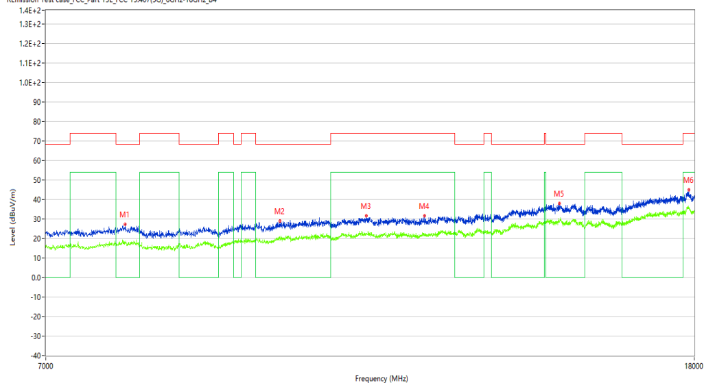
REmission Test case_FCC_Part 15E_FCC 15.407(5G)_6GHz-18GHz_B4
