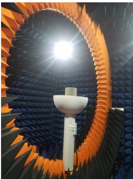
图 3 Satimo 暗室测试系统
