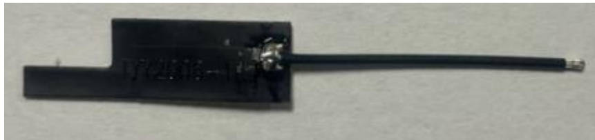
图 2 TYY2006-1P WIFI 天线成品(线长 25mm)
