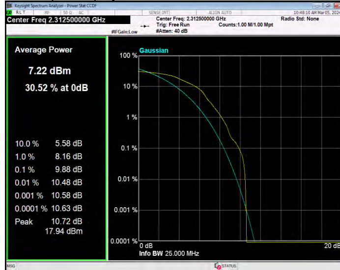
Band40(2305-2315) QPSK BW=10MHz Channel=38750 RB Size=1 Position=#0
