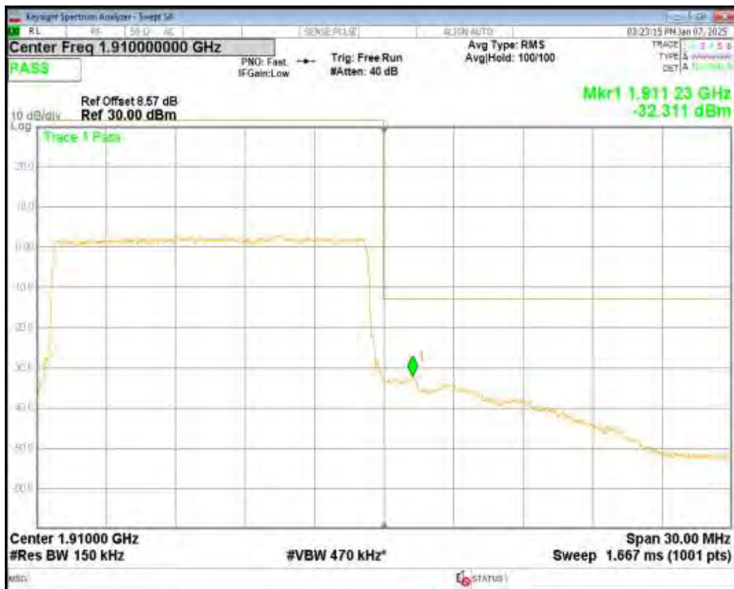
Band2 QPSK BW=20MHz Channel=18700 RB Size=100 Position=#0
