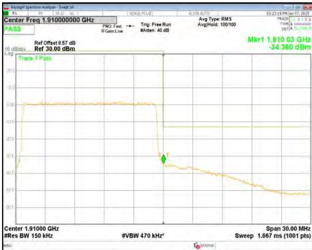
Band2 16QAM BW=20MHz Channel=18700 RB Size=100 Position=#0
