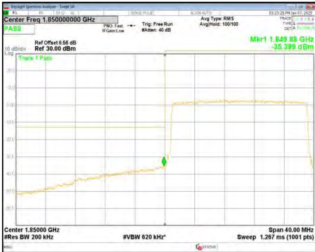
Band2 QPSK BW=20MHz Channel=19100 RB Size=100 Position=#0
