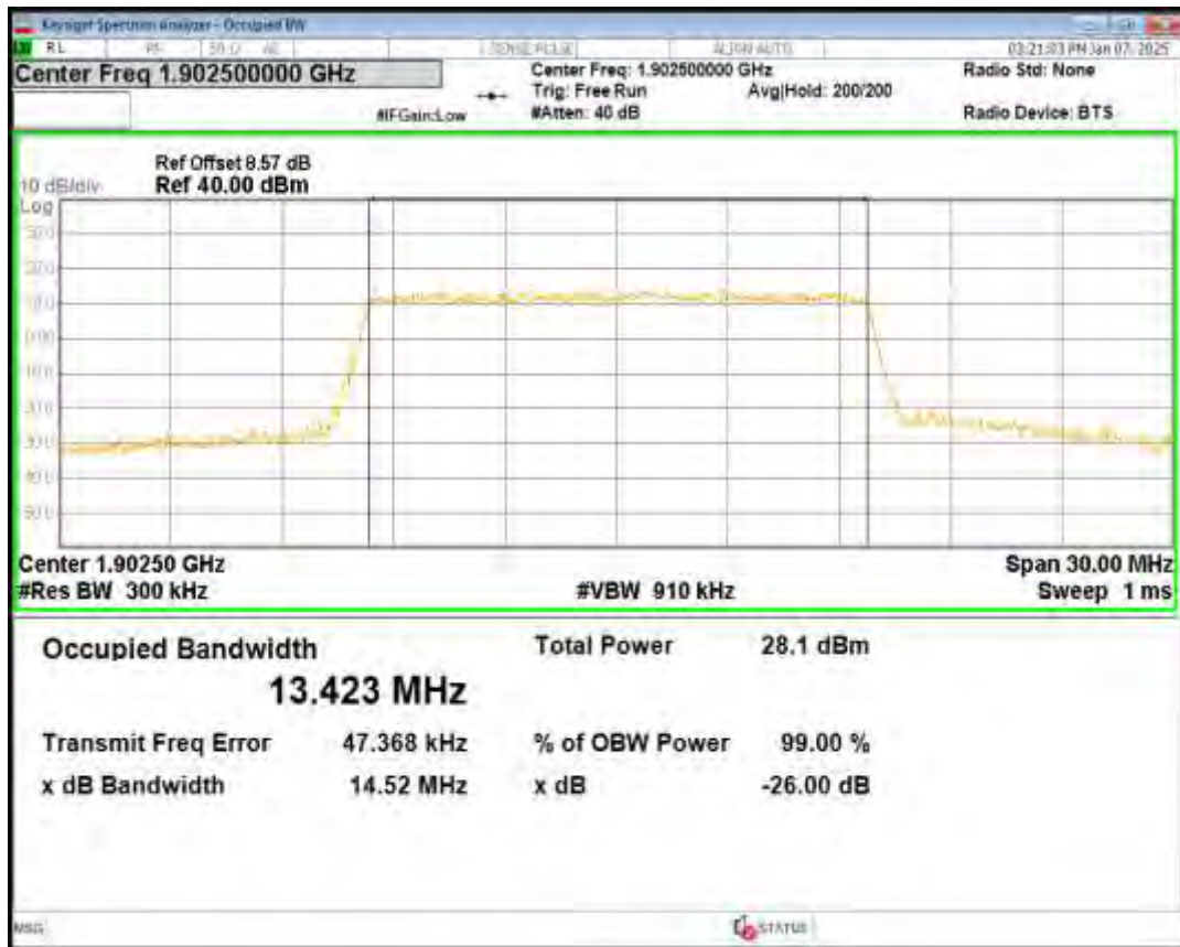
Band2 16QAM BW=20MHz Channel=18700 RB Size=100 Position=#0
