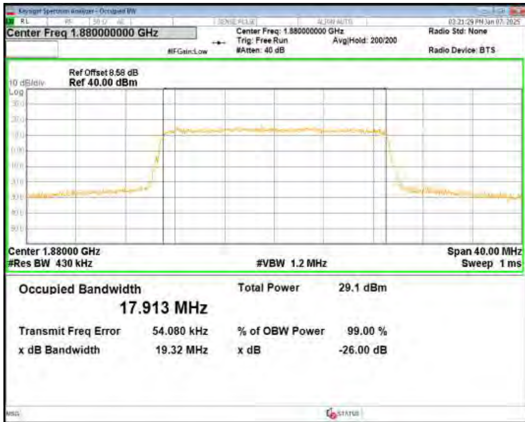
Band2 QPSK BW=20MHz Channel=19100 RB Size=100 Position=#0
