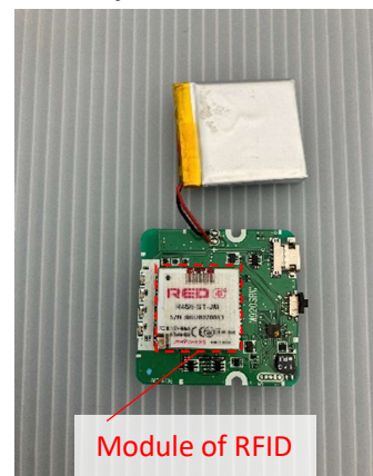
Battery side (Substrate)
