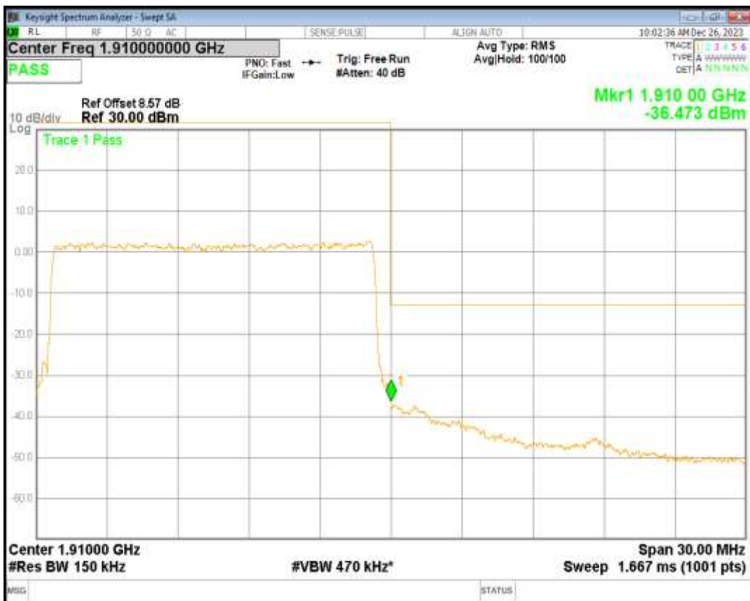
Band2 QPSK BW=20MHz Channel=18700 RB Size=100 Position=#0
