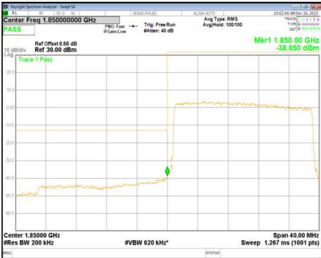
Band2 QPSK BW=20MHz Channel=19100 RB Size=100 Position=#0
