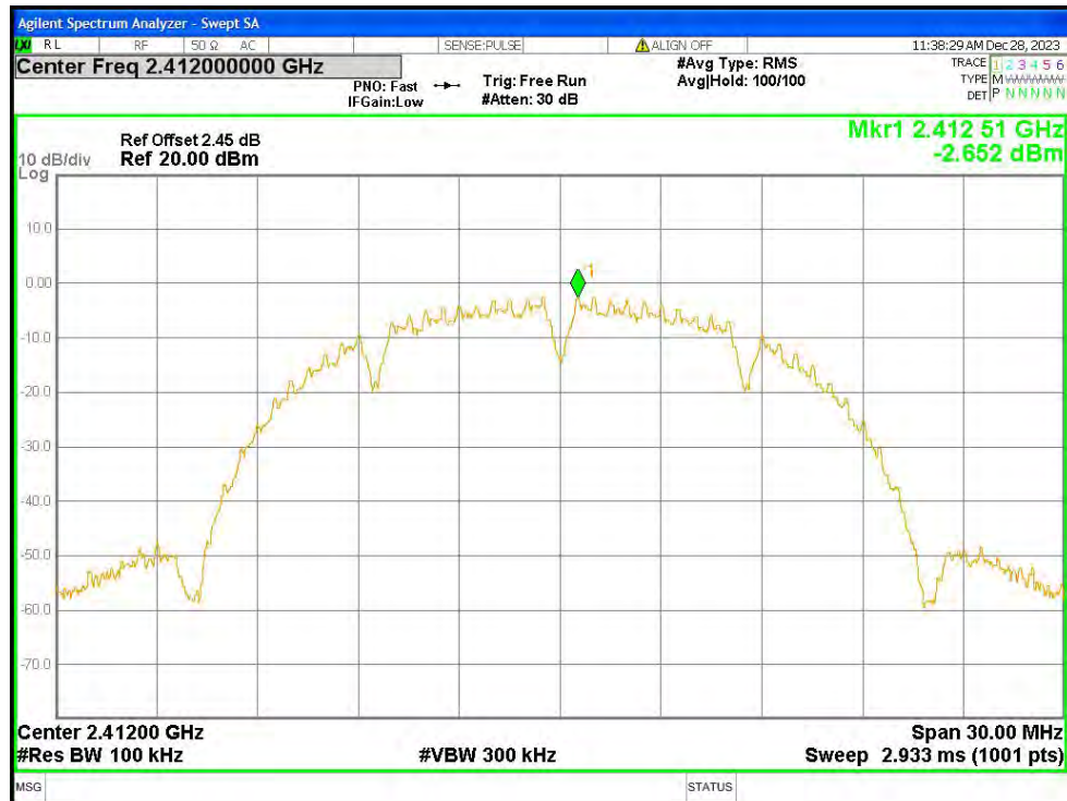
Band Edge NVNT b 2412MHz Ant1 Ref
