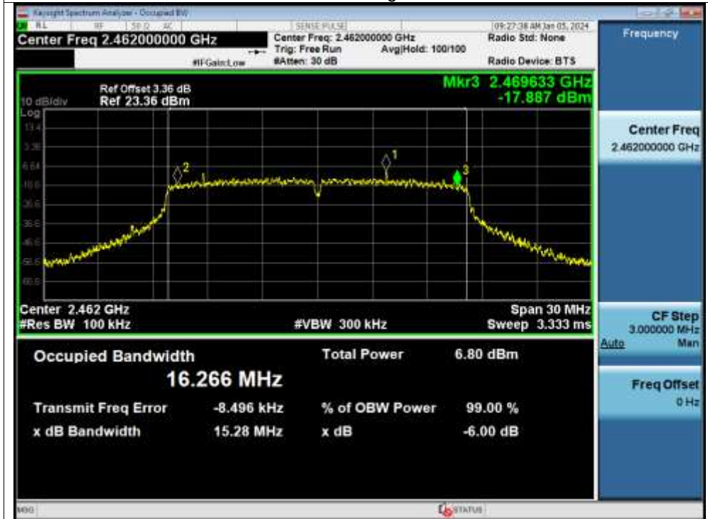
-6dB Bandwidth NVNT g 2462MHz Ant1
