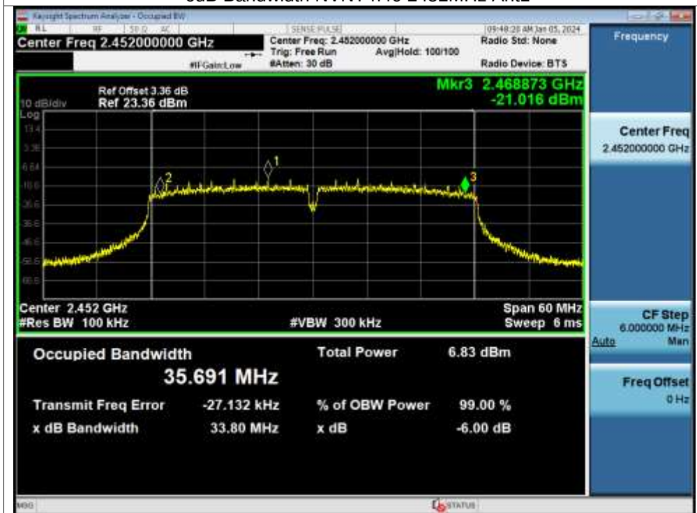
-6dB Bandwidth NVNT n40 2452MHz Ant1
