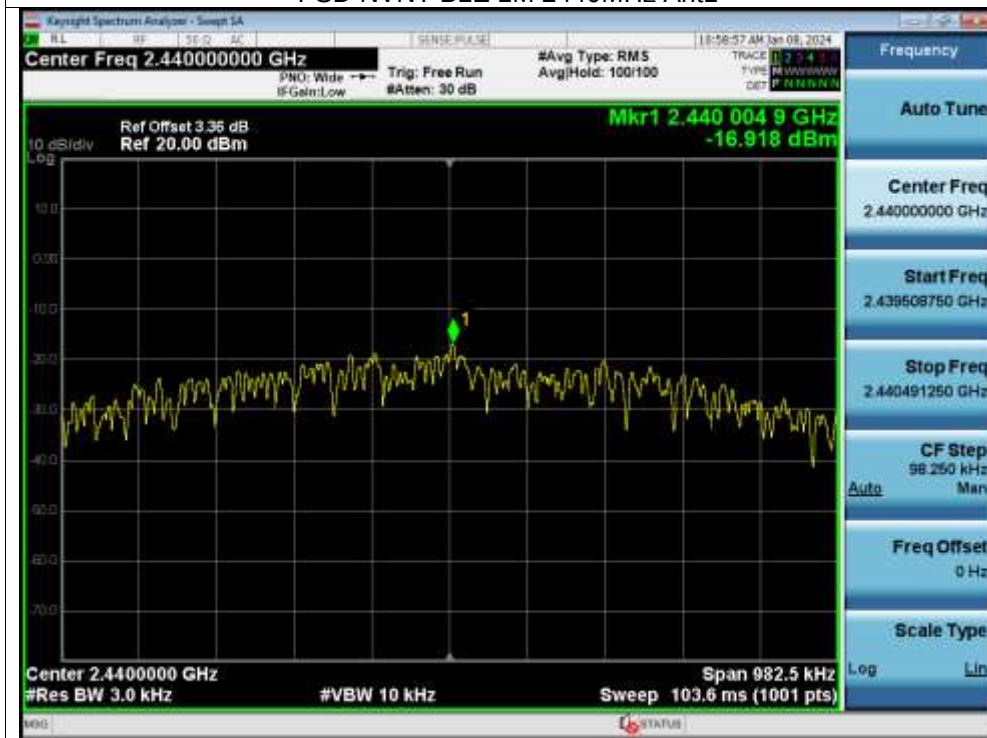
PSD NVNT BLE 1M 2440MHz Ant1
