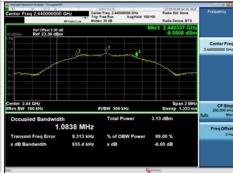
-6dB Bandwidth NVNT BLE 1M 2440MHz Ant1
