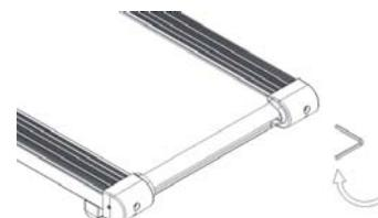
3. Wenn sich das Laufband nach rechts abweicht, drehen Sie die rechte Einstellschraube um eine Vierteldrehung im Uhrzeigersinn und halten Sie 30 Sekunden lang inne, dann kehrt das Laufband automatisch in den Normalzustand zurück. Wenn es nicht in den Normalzustand zurückkehrt, wiederholen Sie bitte die oben beschriebene Methode zur Anpassung.
