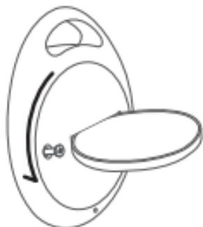
2. Remplacez la batterie par une nouvelle batterie de type CR2032, en plaçant le côté positif de la batterie vers le haut;
