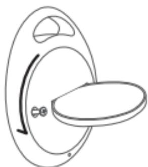
2. Sostituire la batteria con una nuova pila di tipo CR2032, posizionando il lato positivo della pila verso l'alto;
