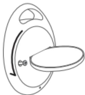
2. プラス側が上になるように、新しいCR2032タイプのバッテリーと交換してください。
