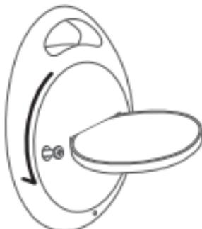
2. Vyměňte baterii za novou baterii typu CR2032, přičemž kladný pól baterie musí být nahoru;
