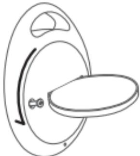
2. Reemplaza la batería por una nueva pila de tipo CR2032, colocando el lado positivo de la pila hacia arriba;
