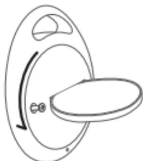
2. Ersetzen Sie die Batterie durch eine neue CR2032-Batterie, wobei die positive Seite der Batterie nach oben zeigt;
