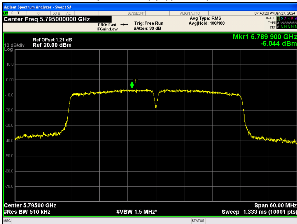
PSD NVNT n40 5795MHz Ant1
