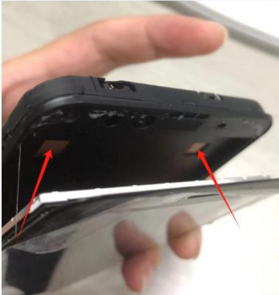
主板贴两个海绵接地
