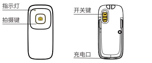
1. 拨动遥控器背面开关(ON开启/OFF关闭), 遥控器指示灯自动闪烁。
