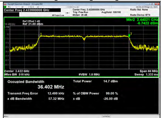
IEEE 802.11n_Channel 11_20MHz_Antenna 0
