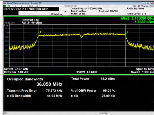
IEEE 802.11n_Channel 6_40MHz_Antenna 0
