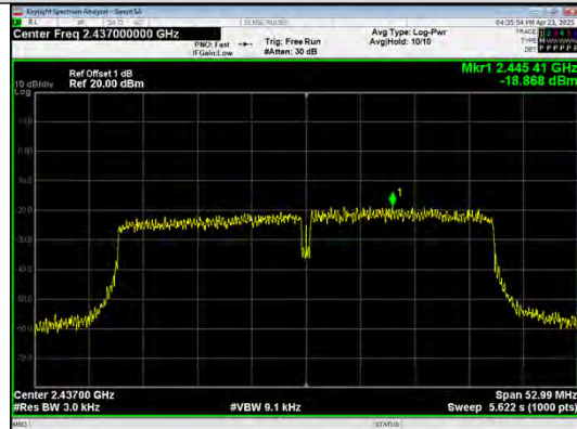
IEEE 802.11n_Channel 11_20MHz_Antenna 0
