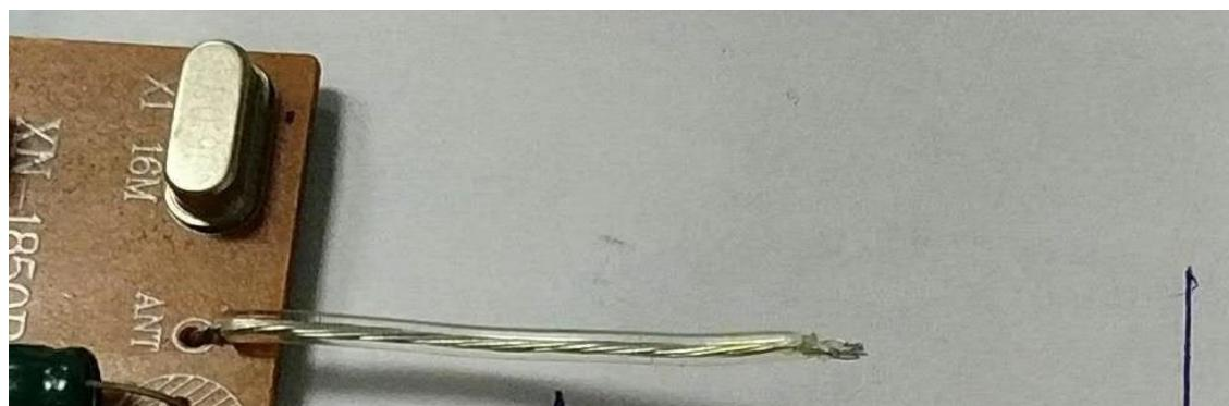
备注：2.4G 透明天线规格为 9 芯外径 1.3MM 镀锡铜导线，透明色，长度为 40MM,线头剥皮 3MM 上锡。符合环保标准：欧盟 EN71(19E)、ROHS、PAHS、6P~16P、欧美 CPSIA、HR4040。
