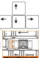
电源开关示意图 Power switch
