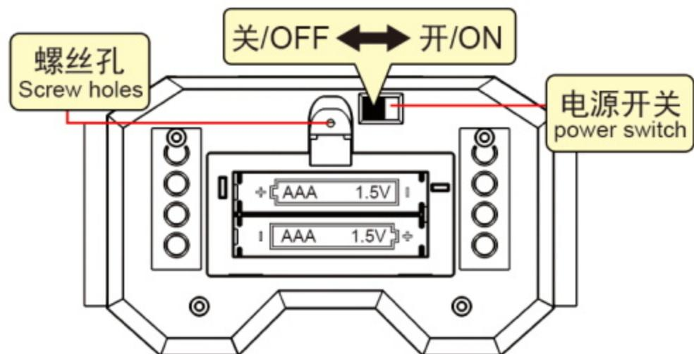
●用螺丝刀拧开后盖螺丝，按照电池的正确极性装入2节1.5V AAA非充电电池（非赠送，需自购）。
