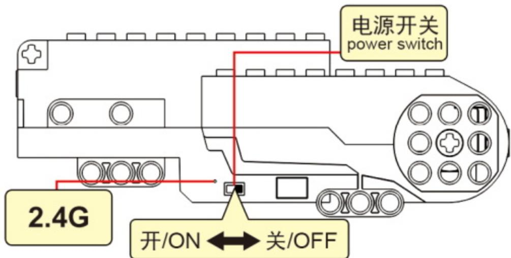
●2.4G对频说明：先将锂电池电源开关打开，再将遥控器电源开关打开，车底电源指示灯为对频时闪烁，对频成功后灯常亮，遥控器对频时指示灯闪烁，待指示灯熄灭为对频成功。
