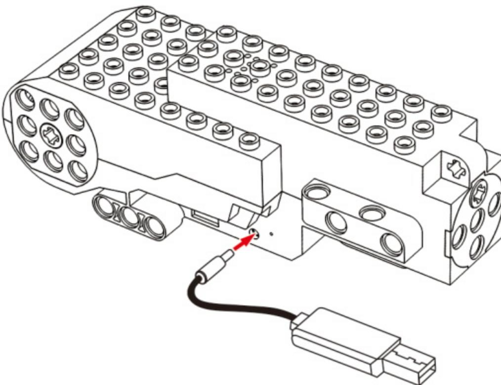
●产品内置充电锂电池首次使用需要先充好电，先将USB充电插头插入手机充电器或者充电宝设备（不建议使用2A以上的充电设备），再将电池插头插入USB充电线插座，充电时USB插头亮红色指示灯，充满后红灯灭，充电时间约为3小时。
