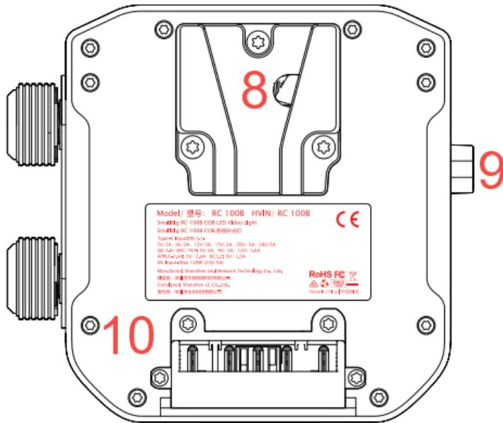
⑧V 口挂板母座: 提供 V 口电池以及 NP-F 电池挂板安装功能。
