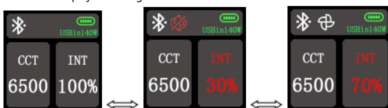
开机后，长按蓝牙/ 静音控制键可重置蓝牙连接，此时蓝牙图标将快速闪烁，您可以打开 SmallGoGo 应用，根据开机提示的蓝牙后缀为设备组网。如果您未下载 SmallGoGo，请扫描以下二维码了解/ 下载，或者在 Google Play/ App store 等应用商店搜索下载。
