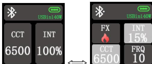
在色温模式或特效模式下，长按该按钮 2 秒可存储当前参数，并进入预设模式 (PRESET)。旋转 INT 旋钮以选择预设，并单击确认。再次长按按钮 2 秒或选择预设以退出。最多可存储 4 组预设参数。屏幕显示将如下变化：
