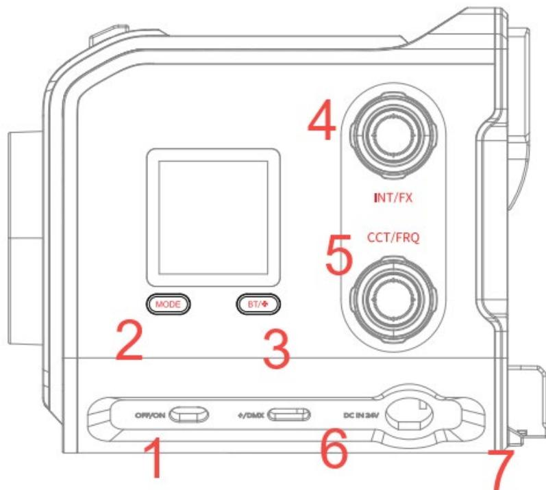
① 开关机按钮：接通电源后，拨动至“ON”并旋转 INT 旋钮一圈进行 RC 100B 开机操作；拨动至“OFF”关机。白色开机界面底部会显示设备蓝牙名称后缀。此时屏显变化如下
