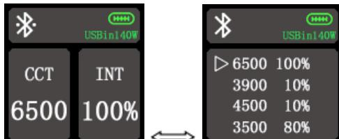
③ 蓝牙/ 静音控制键 (BT)：双击该按键可循环切换 RC 100B 的工作模式。可通过观察左上图标查看 RC 100B 工作模式。无图标：正常模式，不限制亮度；红色静音图标：静音模式，限制 30% 亮度模式；白色风扇图标：低风噪模式，限制 70% 亮度模式，此时图标显示如下：
