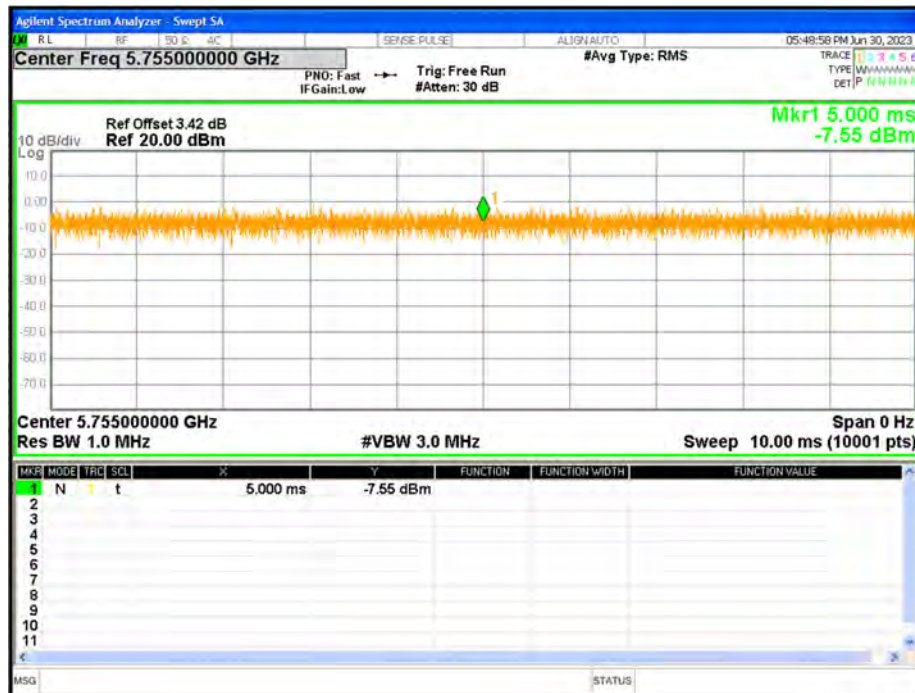
Duty Cycle NVNT n40 5755MHz Ant1
