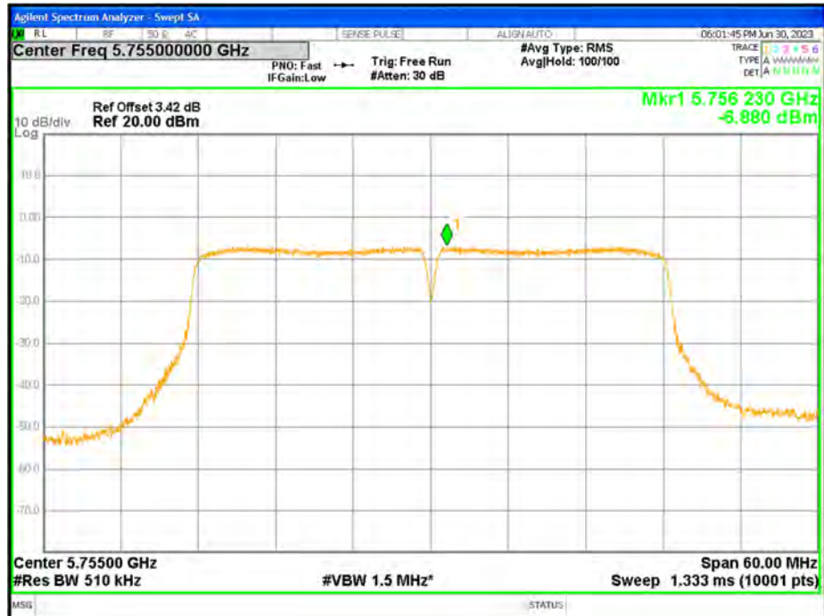
PSD NVNT ac40 5755MHz Ant1
