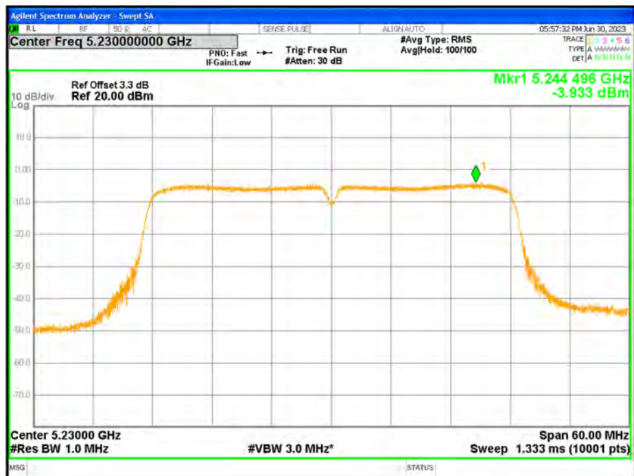
PSD NVNT ac40 5230MHz Ant1
