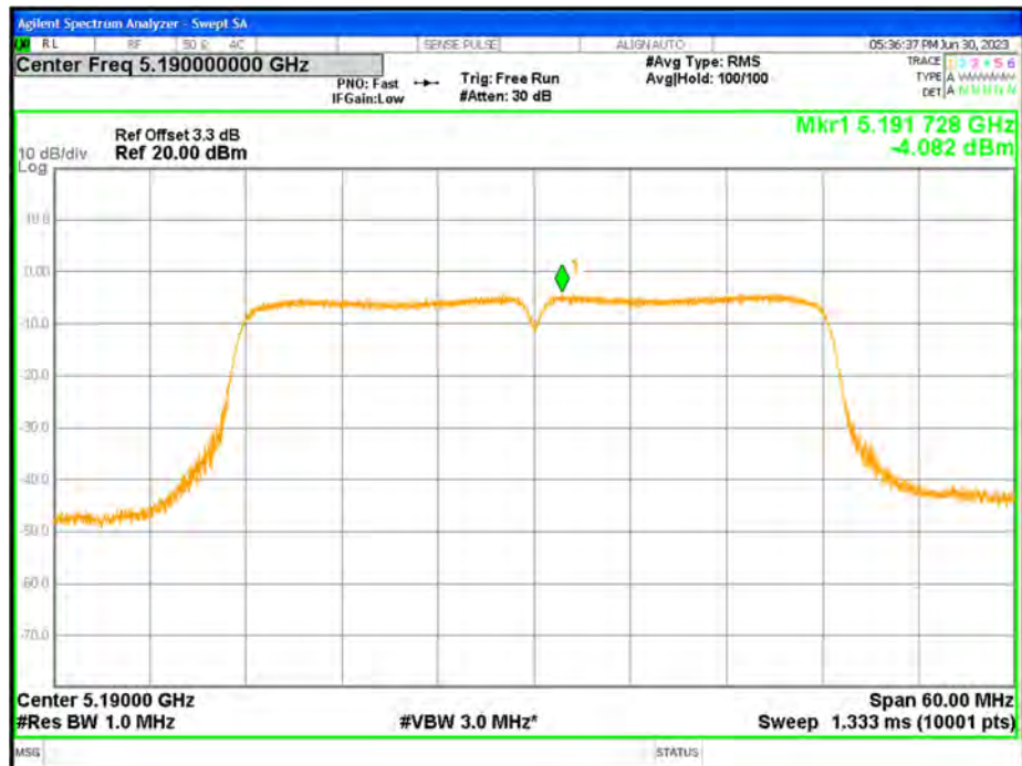
PSD NVNT n40 5190MHz Ant1
