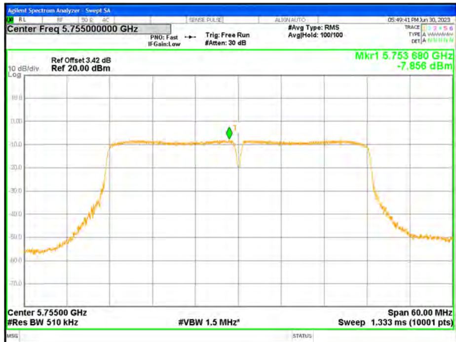
PSD NVNT n40 5755MHz Ant1
