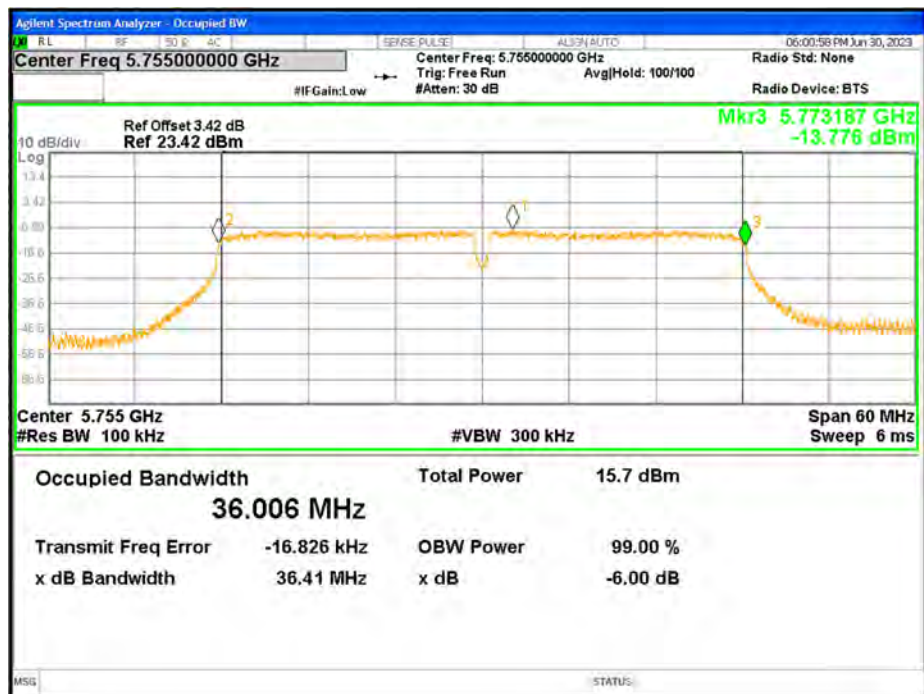
-6dB Bandwidth NVNT ac40 5755MHz Ant1
