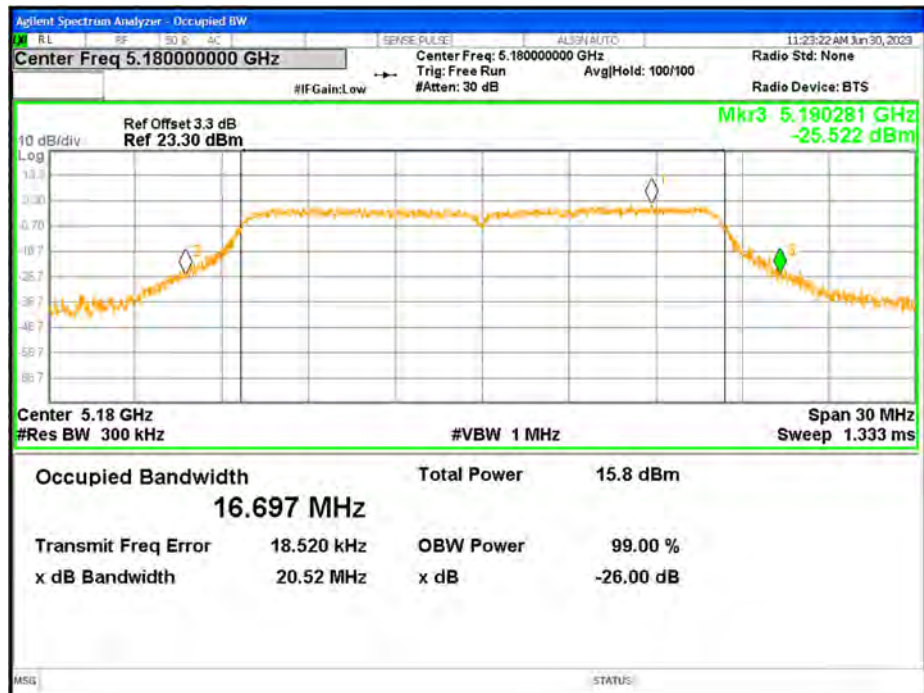
-26dB Bandwidth NVNT a 5180MHz Ant1
