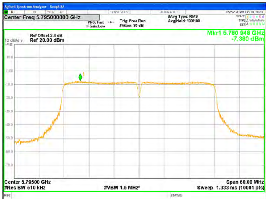
PSD NVNT n40 5795MHz Ant1
