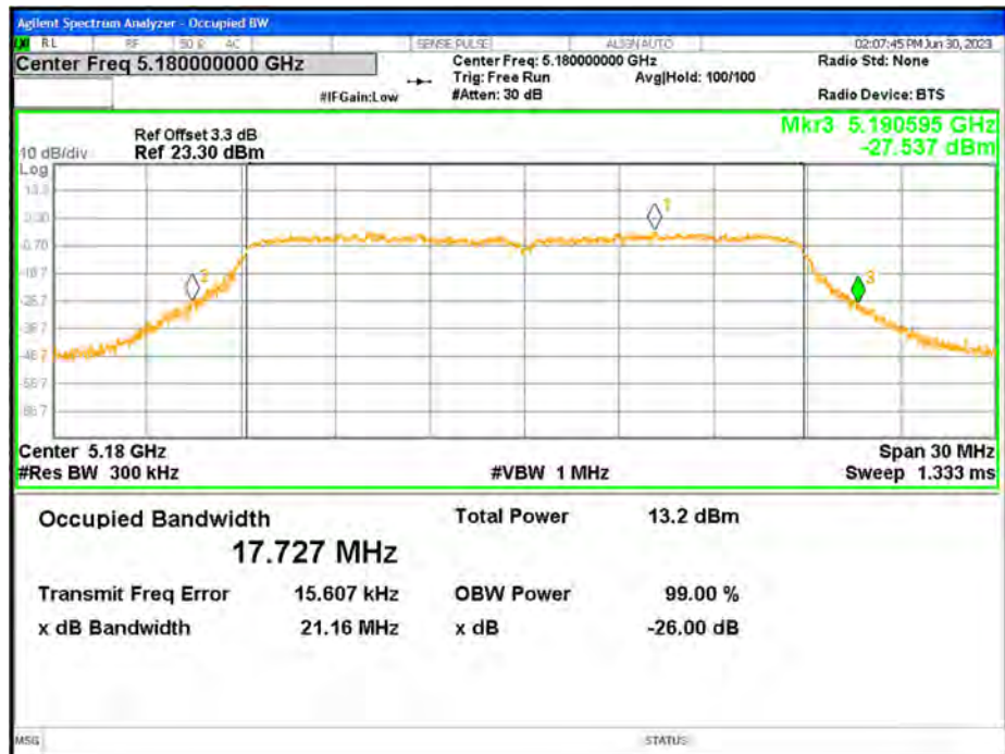
-26dB Bandwidth NVNT ac20 5180MHz Ant1
