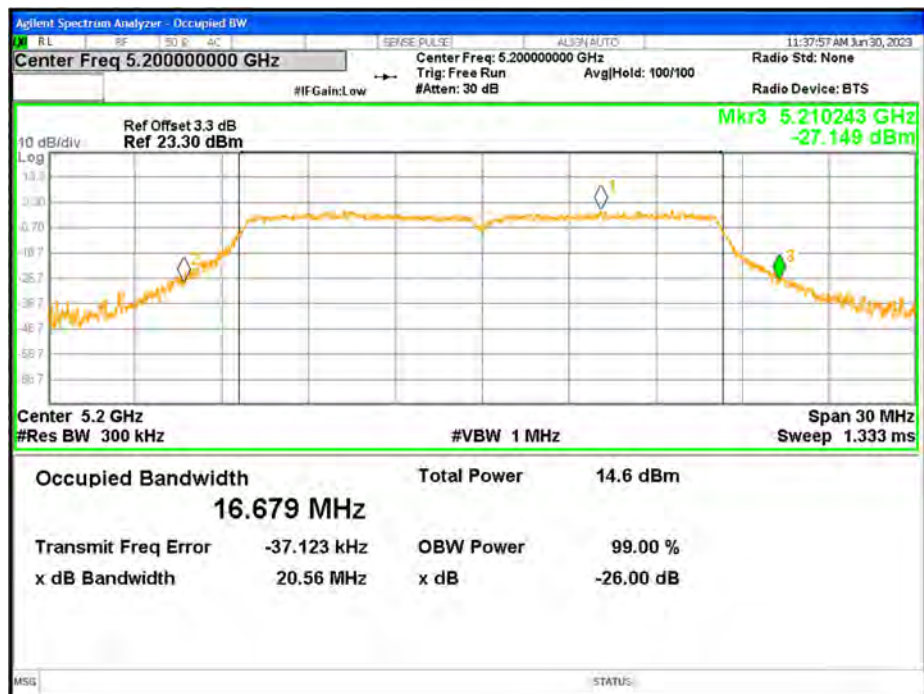
-26dB Bandwidth NVNT a 5200MHz Ant1
