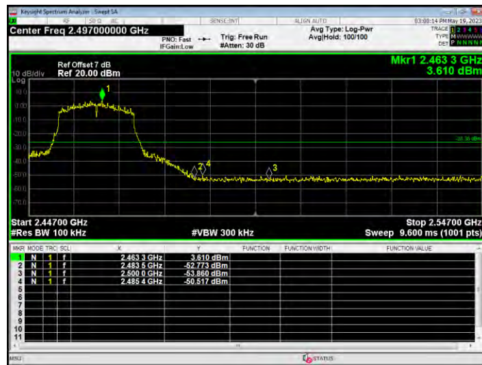
Band Edge NVNT n20 2412MHz Ant1 Ref
