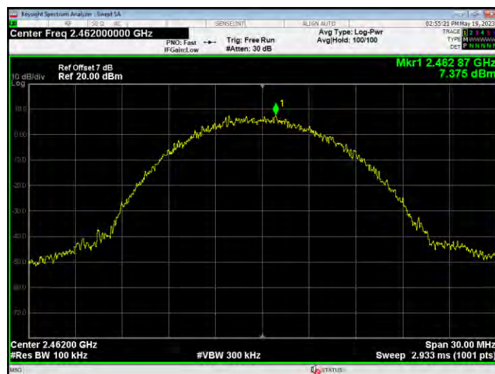
Band Edge NVNT b 2462MHz Ant1 Ref
