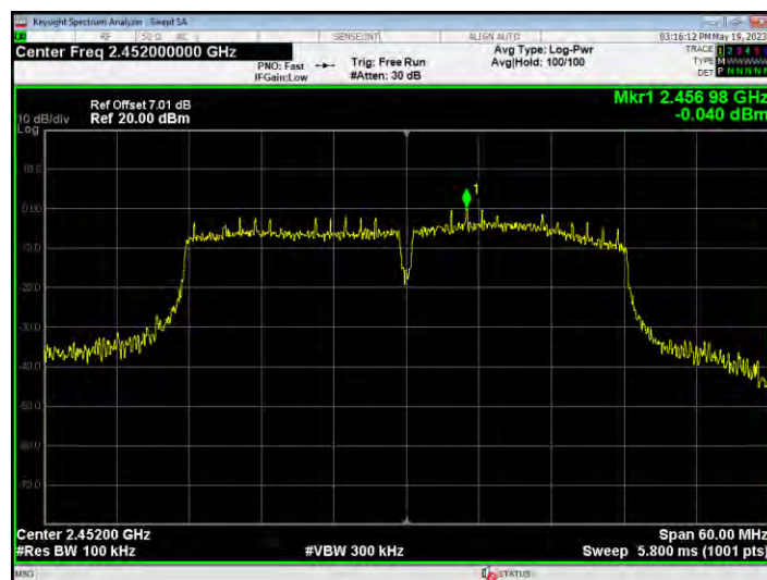
Band Edge NVNT n40 2452MHz Ant1 Ref
