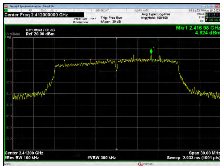
Band Edge NVNT n20 2412MHz Ant1 Ref
