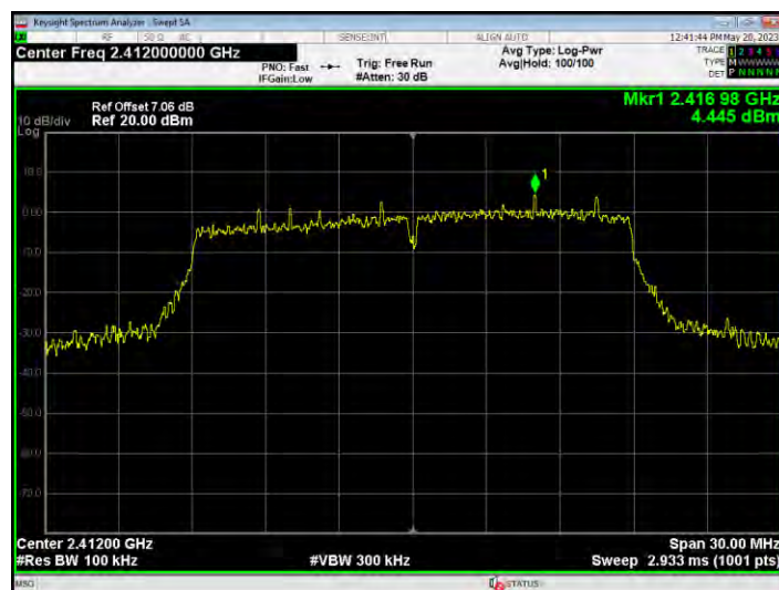
Band Edge NVNT n20 2412MHz Ant1 Ref
