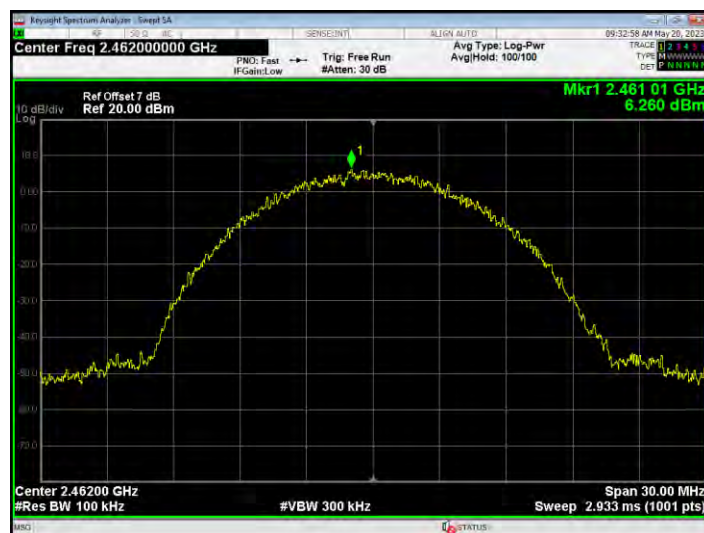
Band Edge NVNT b 2462MHz Ant1 Ref
