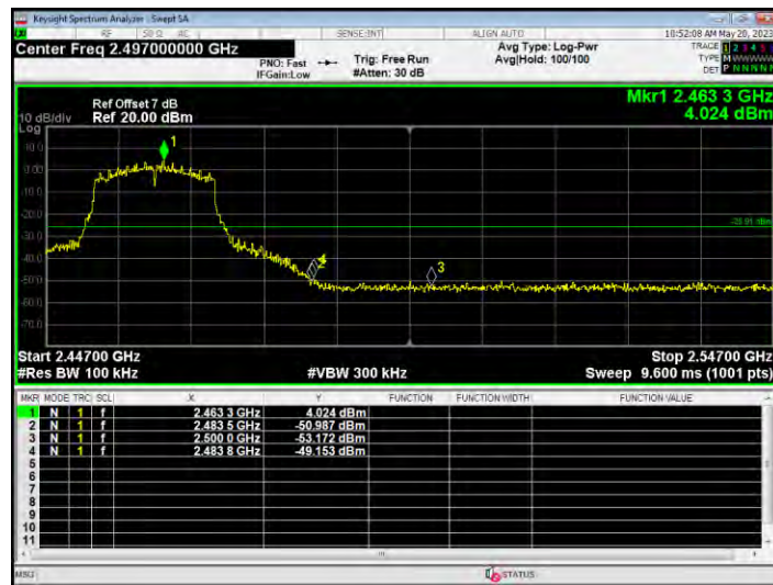
Band Edge NVNT n20 2412MHz Ant1 Ref
