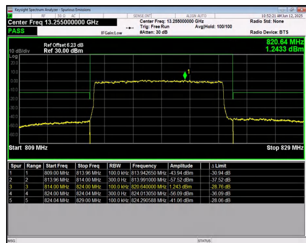
n26(814-824) SCS=15kHz DFT_64QAM BW=10MHz LowChannel=163800 RB=50@0
