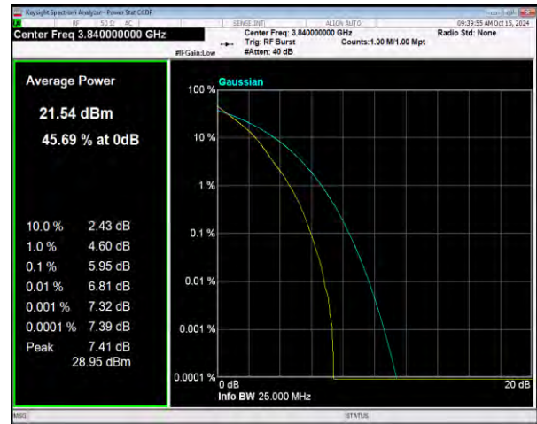
n77(3700-3980) SCS=30kHz DFT_QPSK BW=20MHz Channel=656000 RB=50@0
