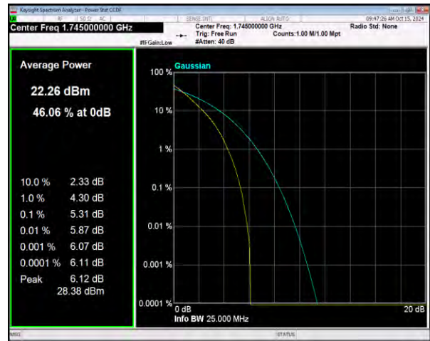
n66 SCS=15kHz DFT_QPSK BW=20MHz Channel=349000 RB=100@0
