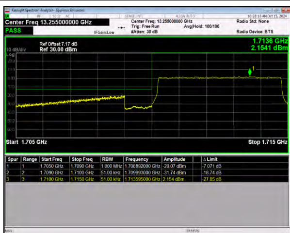
n66 SCS=15kHz CP_QPSK BW=5MHz LowChannel=342500 RB=25@0
