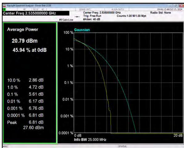
n7 SCS=15kHz DFT_16QAM BW=20MHz Channel=507000 RB=100@0
