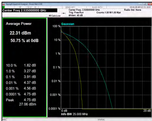
n7 SCS=15kHz DFT_BPSK BW=20MHz Channel=507000 RB=100@0
