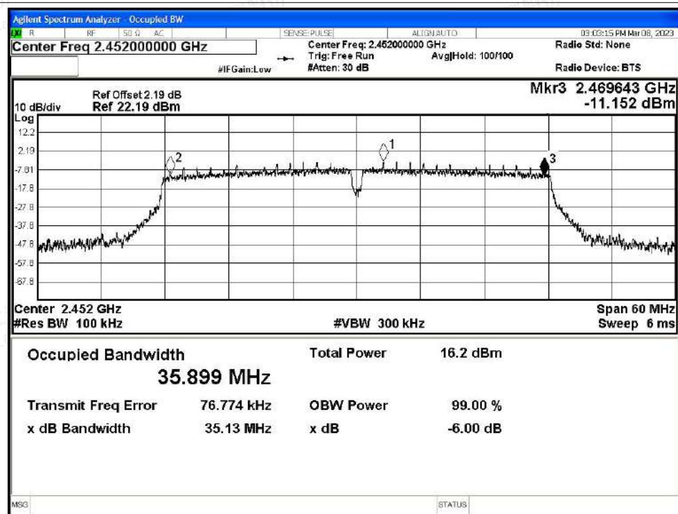
-6dB Bandwidth NVNT n40 2452MHz Ant1
