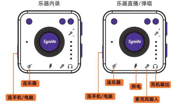
Synido LiveDock A20一款便携式乐器内录转换器。内置双核芯片，高性能 32 位 DSP 内核。独立AD/DA转换，支持24-bit, 96 kHz音频采样。
