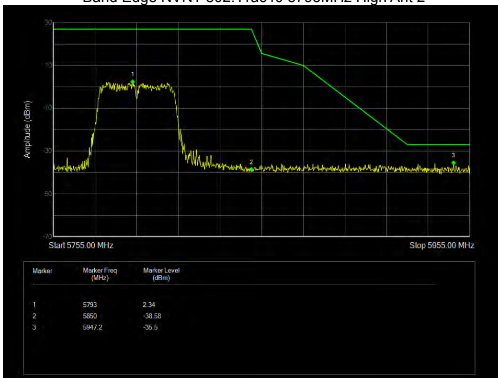
Band Edge NVNT 802.11ac80 5775MHz High Ant 1
