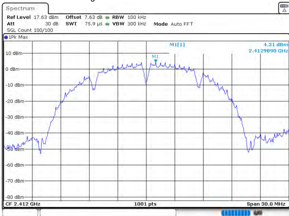
Band Edge NVNT 802.11b 2412MHz Ant 1 Ref
