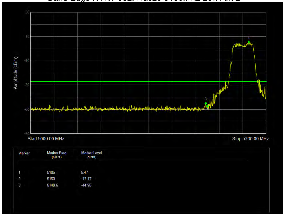
Band Edge NVNT 802.11ac20 5180MHz Low Ant 2
