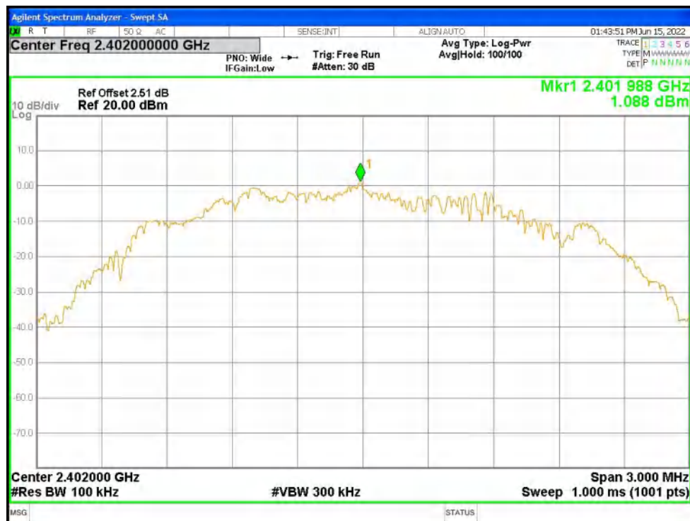
PSD NVNT BLE 2M 2442MHz Ant1
