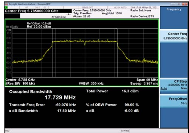
U-NII-3 6dB Bandwidth-802.11n(40MHz) ,5755MHz,Ant0
