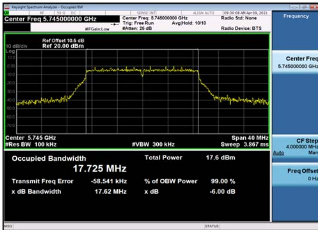
U-NII-3 6dB Bandwidth-802.11n(20MHz) ,5825MHz,Ant0
