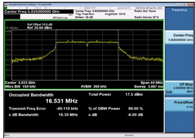
U-NII-3 6dB Bandwidth-802.11ac(20MHz) ,5785MHz,Ant0
