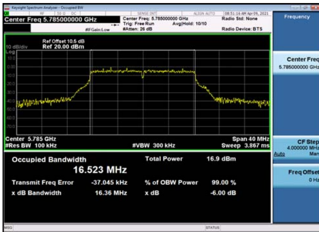
U-NII-3 6dB Bandwidth-802.11ac(20MHz) ,5745MHz,Ant0
