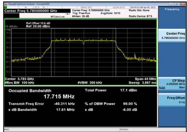
U-NII-3 6dB Bandwidth-802.11ac(40MHz) ,5755MHz,Ant0
