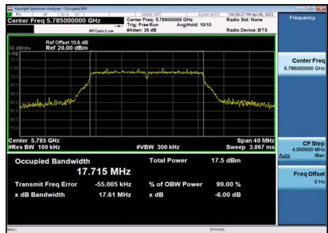
U-NII-3 6dB Bandwidth-802.11n(40MHz) ,5755MHz,Ant1
