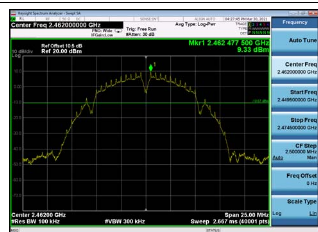
,Plot 2,Band Edge-802.11b,2437MHz ,Ant0
