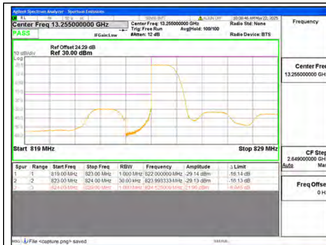
B18 part22 / 5MHz / Low CH / QPSK / 1 RB
