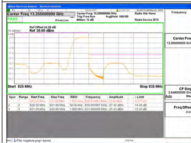
B18 part22 / 5MHz / High CH / QPSK / 1 RB
