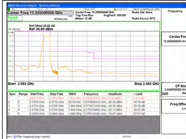
B7 / 5MHz / High CH / QPSK / 1 RB
