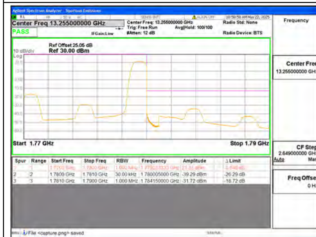
B66 / 10MHz / High CH / QPSK / 1 RB
