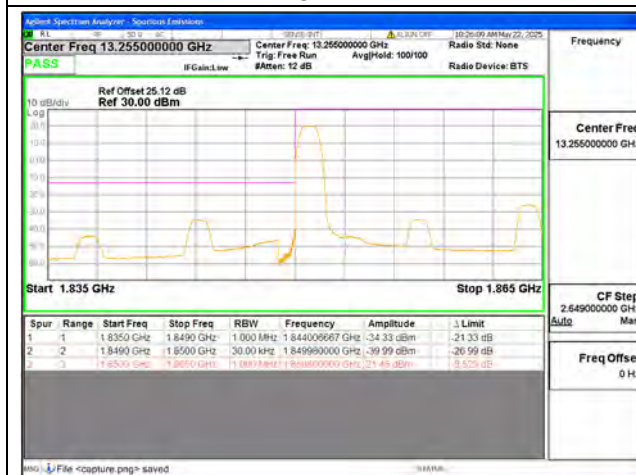
B25 / 15MHz / Low CH / QPSK / 1 RB
