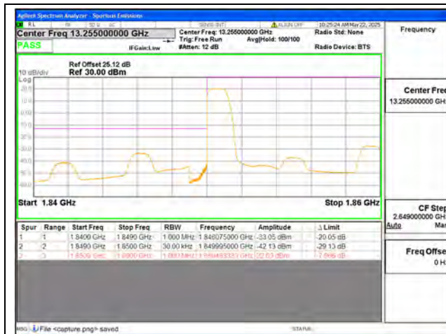
B25 / 10MHz / Low CH / QPSK / 1 RB
