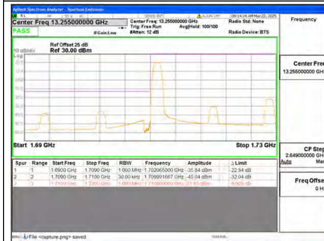
B4 / 20MHz / Low CH / QPSK / 1 RB
