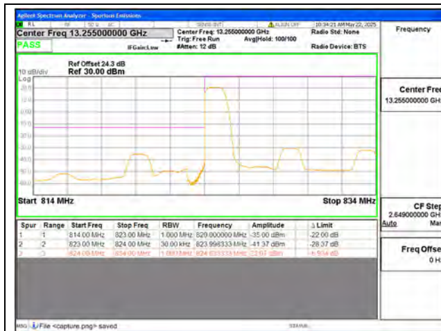
B26 Part22 / 10MHz / Low CH / QPSK / 1 RB
