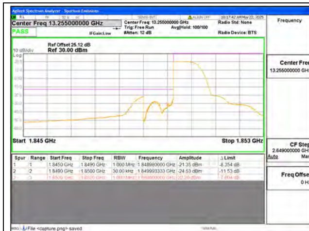
B25 / 1.4MHz / Low CH / QPSK / 1 RB
