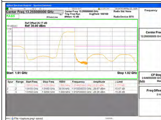
B25 / 5MHz / High CH / QPSK / 1 RB
