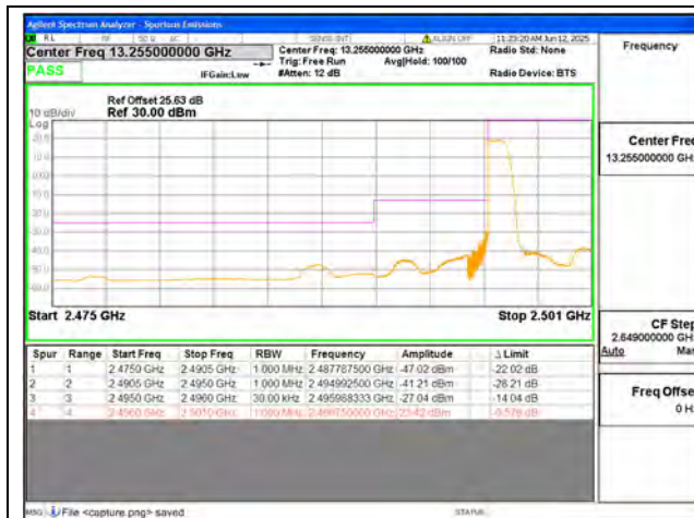
B41 / 5MHz / Low CH / QPSK / 1 RB
