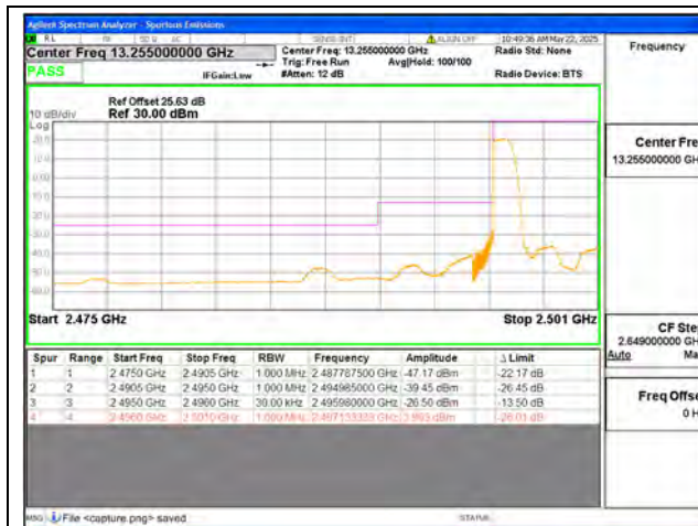
B41 / 5MHz / Low CH / QPSK / 1 RB
