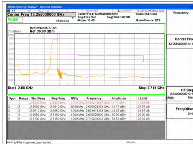
B41 / 10MHz / High CH / QPSK / 1 RB
