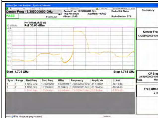
B66 / 3MHz / Low CH / QPSK / 1 RB
