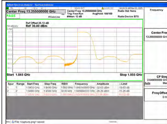
B25 / 5MHz / Low CH / QPSK / 1 RB
