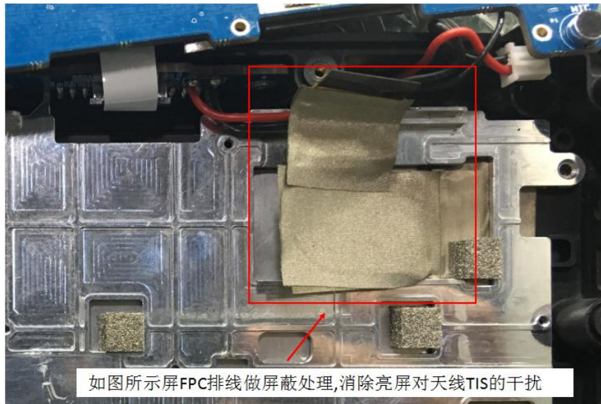
如图所示屏金属背板做接地处理，FPC排线做屏蔽处理
