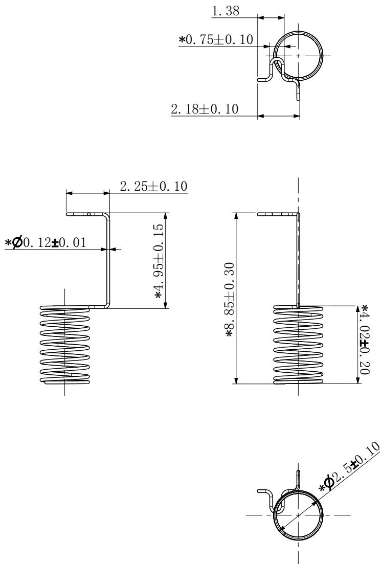
线径:  $\Phi 0.12\text{mm}$
