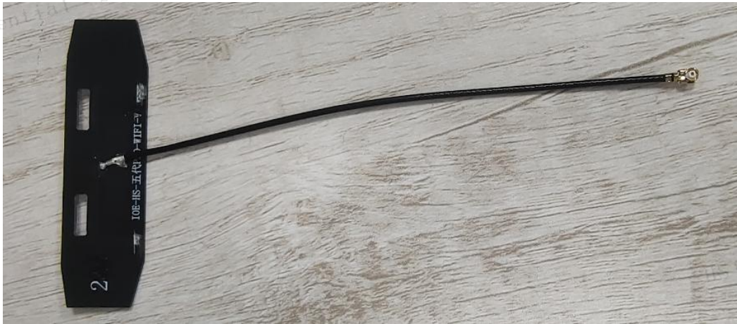
HS-五代 PRO-2#-双频 WIFI 天线 PCB 黑色 To IPEX 一代 OD1.37mm 黑色低损线 L120mm
