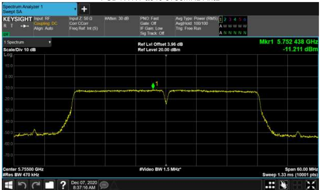
PSD NVNT ac40 5755MHz Ant1
