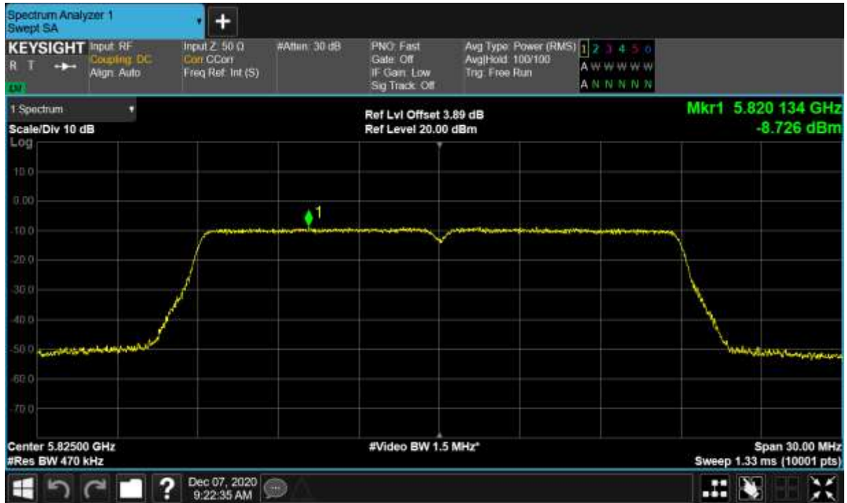
PSD NVNT ac40 5755MHz Ant1
