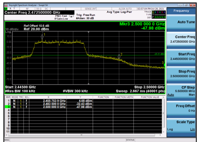
,Plot 2,Band Edge-802.11n(HT20) ,2462MHz,Ant0
