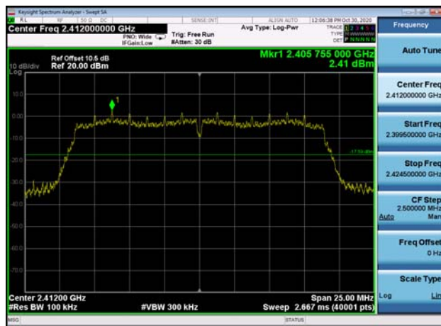
,Plot 1,Reference Level-802.11n(HT20) ,2462MHz
