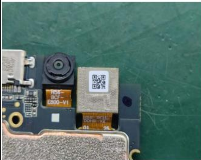
后盖底部钢片贴双面导电布
