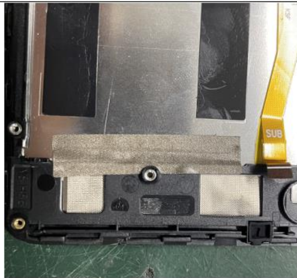
此处贴导电布，使小板地和五金中框导通
