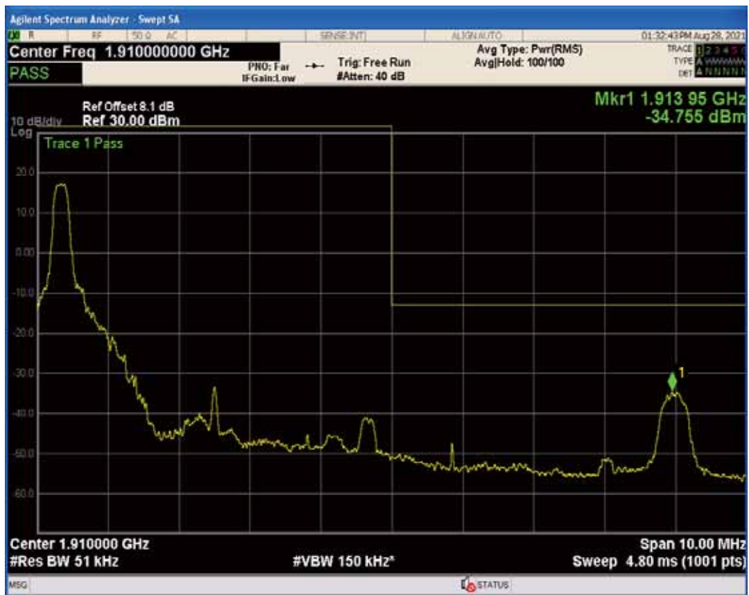
Band2 QPSK BW=10MHz Channel=18650 RB Size=1 Position=#0
