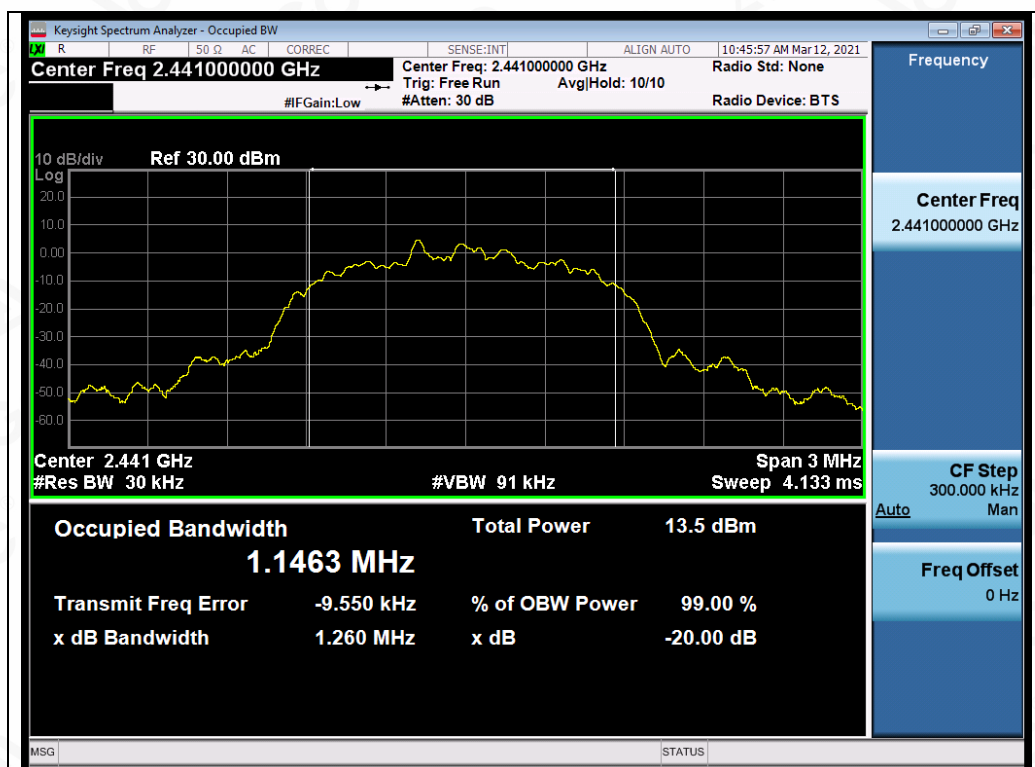
Test_Graph_EDR_ANT1_2441_3Mbps_OBW
