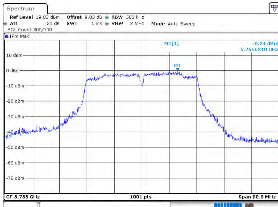
PSD NVNT 802.11n(HT40) 5755MHz Ant 2
