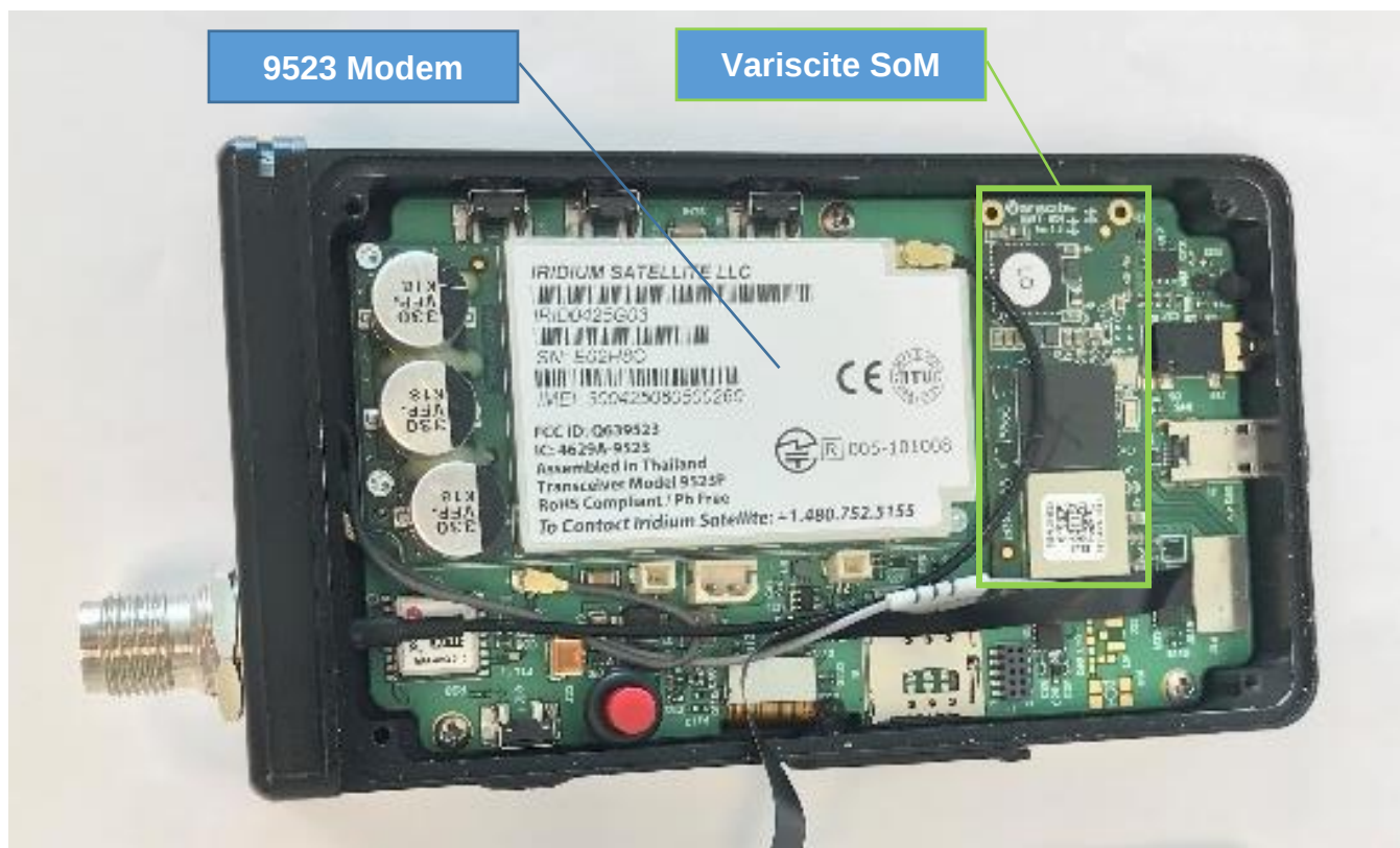
SHOUT sp Main PCBA – Top with 9523 Modem and Variscite SoM module
