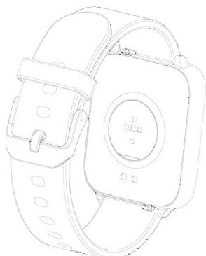
心率传感器 Heart rate sensor      充电接口 Charging port
